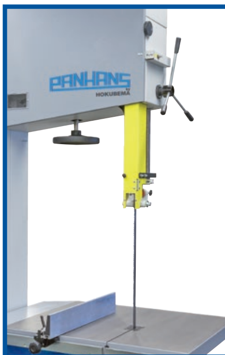
Schnitthöhenenerweiterung - 220 mm > NRA 600/700/800/900 - 400 mm > NRA 700/800
