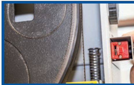
5 Aufvulkanisierter Gummibelag, ballig geschliffen
