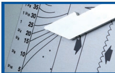
7 Blattspannungsanzeige mit Sichtfenster, zur Einstellung der empfohlenen Spannung
