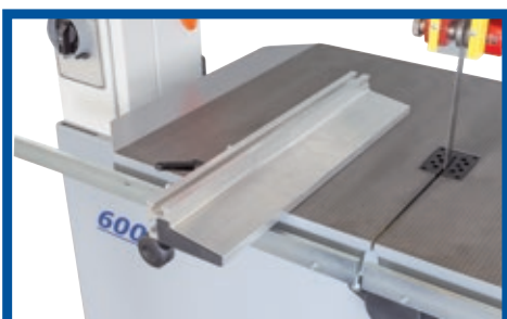
9 umlegbares Anschlaglineal hoch für breite/hohe Teile, flach für kleine Teile
