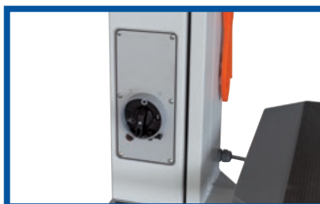
8 Drehnockenschalter mit - Direktanlauf (Modelle 400 - 600) - Stern-/Dreieckanlauf (700 - 900)
