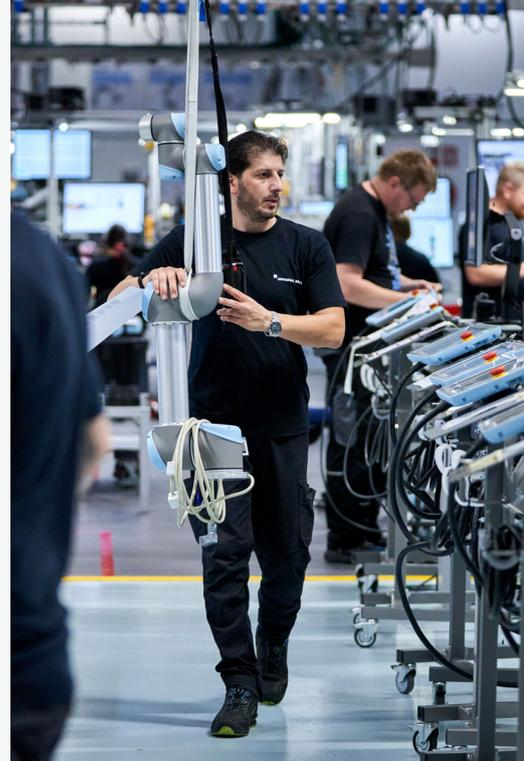
Les cobots e-Series sont certifiés TÜV NORD pour la norme ISO 10218-1 et les fonctions de sécurité sont classées Cat. 3 PL d conformément à la norme ISO 13849-1.
