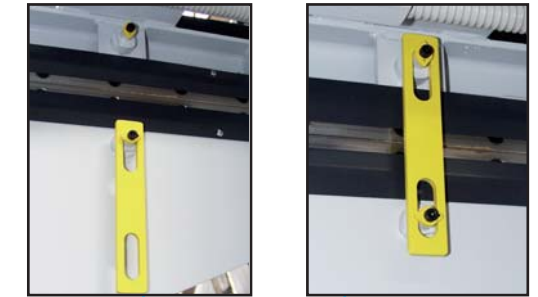
Chiavistello per bloccaggio piani in fase di manutenzione Safety lock Verriegelungshaken für die Heizplatte bei Wartungsarbeiten
