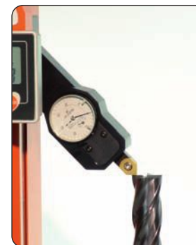
Misurazione dell'altezza How to measure tool length
