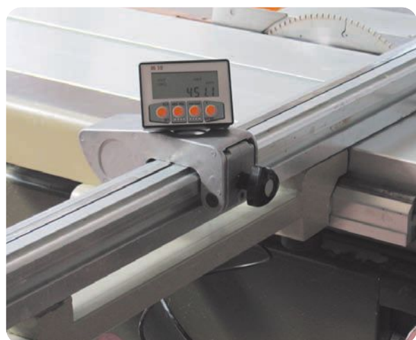
Applicazione su sega circolare lato squadra Application on panel sizing machines for squaring cuts
