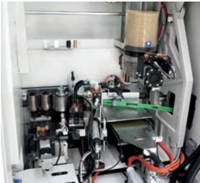
Anleimaggregat für die automatische Anbringung von Rollen- oder Streifenkanten von 0,4 bis 12 mm.
