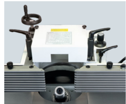
Arbre de fraiseuse Type 2601 avec joues intégrales
