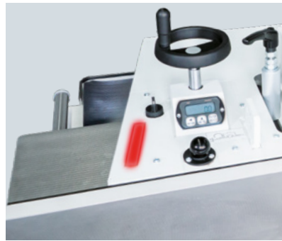
Bande lumineuse de sécurité sur le guide
