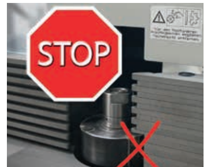
Guardian (die Klemmung der Anschlagbacken wird überwacht)
