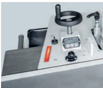
Sicherheitslichtleiste am Fräsanschlag
