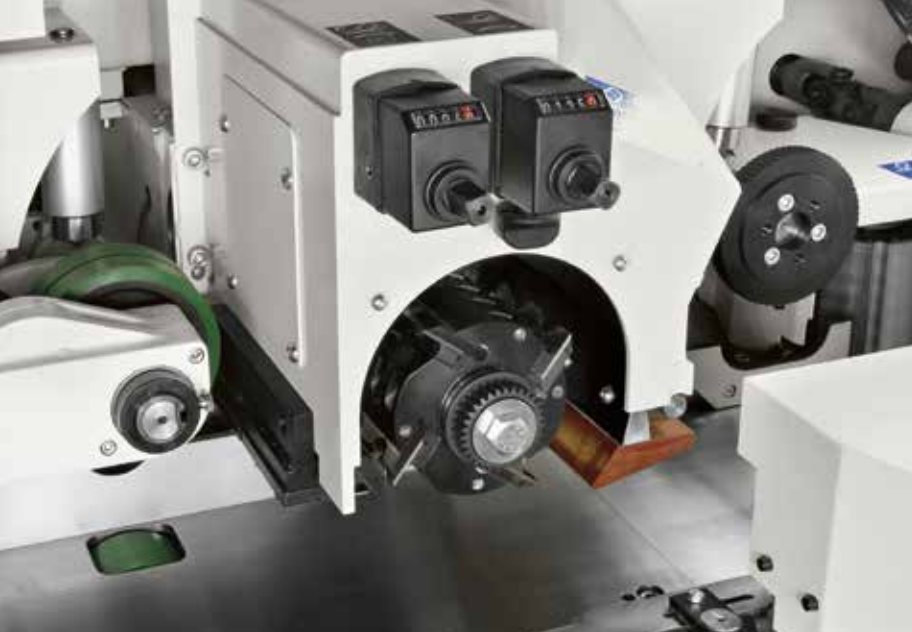
Ausrüstung für Profilbearbeitung mit der oberen Spindel Beinhaltet 2 mechanische Dezimalanzeigen. Min/max Werkzeugdurchmesser 100/180 mm. Axialhub 40 mm. Das Absaugsystem ist besonders leistungsfähig.
