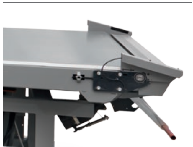
Zusätzlicher Absaugkit für Abladeband, bestehend aus 2 Absaughauben, eine im oberen Teil des Abladebands und die andere am Ende des Bands.
