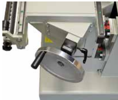
Höhenverstellung nach digitaler Anzeige auf 1/10 mm genau
