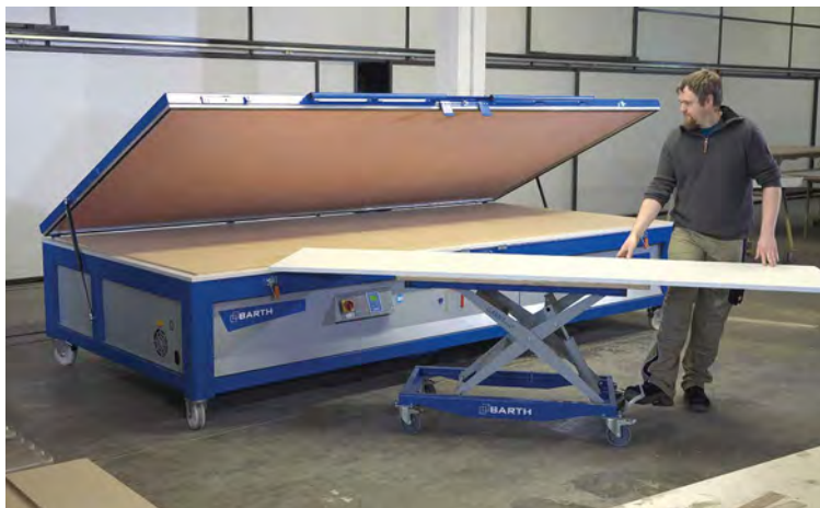
Rastfalle für Öffnung des Membranrahmens mit Deckenkran
